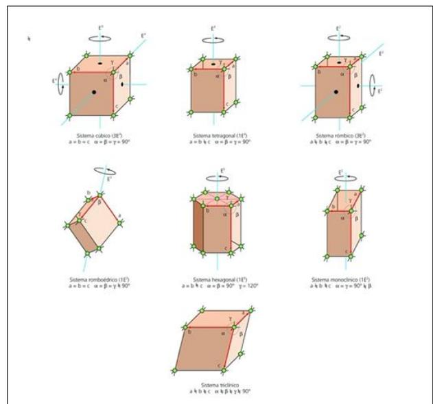
Los 7 sistemas cristalinos y sus simetrías. Las 14 redes de Bravais se obtienen a partir de estos, añadiendo vértices centrados en la celda, centrados en las bases o centrados en las caras. (Fuente: [dimetilsulfuro.es](http://dimetilsulfuro.es)).
